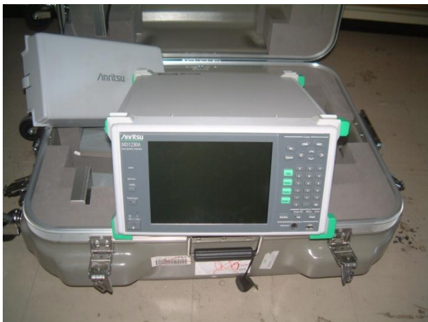
「ネットワーク解析装置」 任意のトラフィックを発生させるなど、 ネットワーク実験には必須 非常に高価
