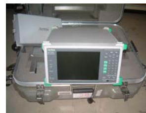
「ネットワーク解析装置」 任意のトラフィックを発生させるなど、 ネットワーク実験には必須 非常に高価
